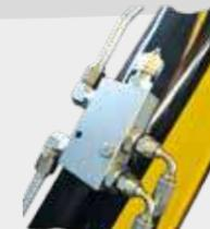
Гидрозамок на цилиндре стрелы. Обеспечивает безопасность в любом положении стрелы, также - не требует участия оператора в фиксации стрелы.
