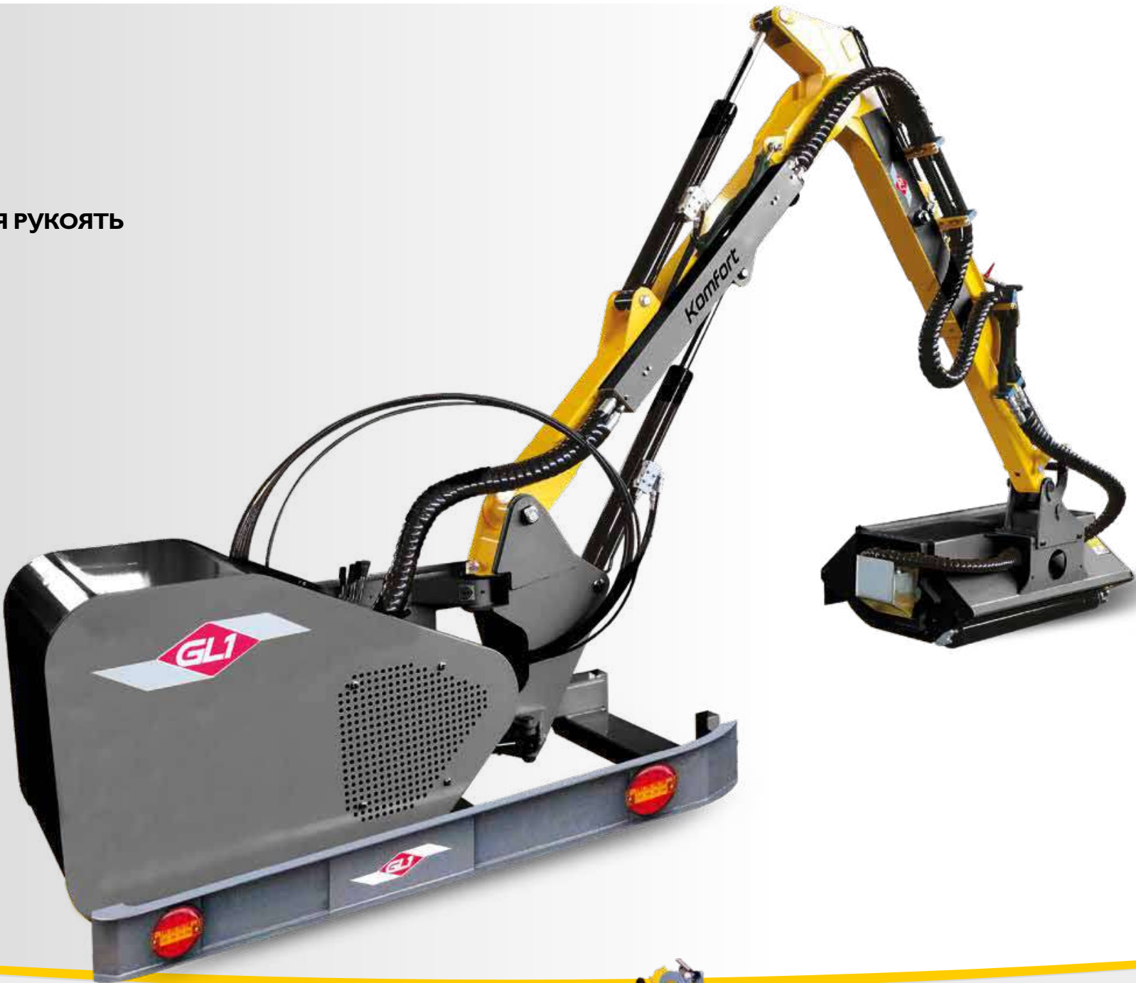
Модель режущей головки DS130/5. Центральное крепление к рукояти, профессиональный опорный ролик с усиленными подшипниковыми узлами, защищенными системой "лабиринт" Крепление головки - сзади для увеличения обзорности для оператора
