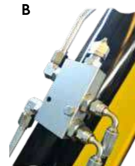
А – Клапан управления давлением в линии гидроцилиндров и линии режущей головки В – гидрозамок цилиндра стрелы
